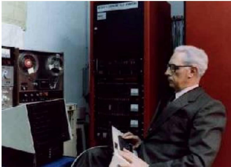
Il TAUMUS è il software di gestione progettato e realizzato per l'impiego del TAU2 in tempo reale con il sistema IBM 370/168 del CNUCE operante in time-sharing. Quest'ultima caratteristica rendeva possibile l'utilizzo in remoto del TAUMUS - TAU2 da più utenti in contemporanea che potevano chiedere in qualsiasi momento di gestire l'archivio di musica del programma per memorizzare o reperire ed eseguire brani
