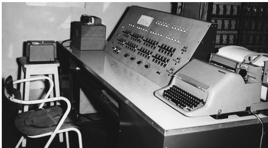
Fig. 2. Il quadro di comando manuale della Macchina Ridotta del 1957
