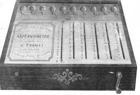
Arithmètre. — Machine à calculer de M. Thomas (de Colmar).
