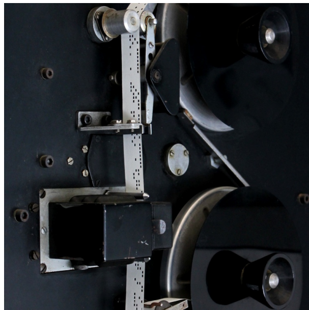
Il dettaglio della testina fotoelettrica su un lettore Olivetti al Museo degli Strumenti per il Calcolo
