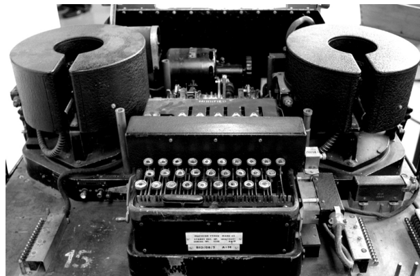
Una TypeX di Bletchley Park, modificata per essere usata come una Enigma
